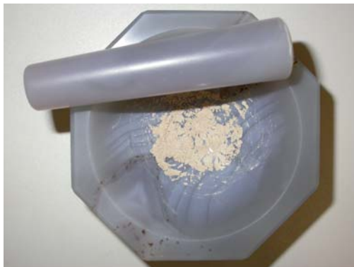
Abbildung A-19: Achatmörser mit einer Harnsteinprobe. a) Probe unzerlegt; b) Probe grob zerlegt; c) Probe pulverisiert.
